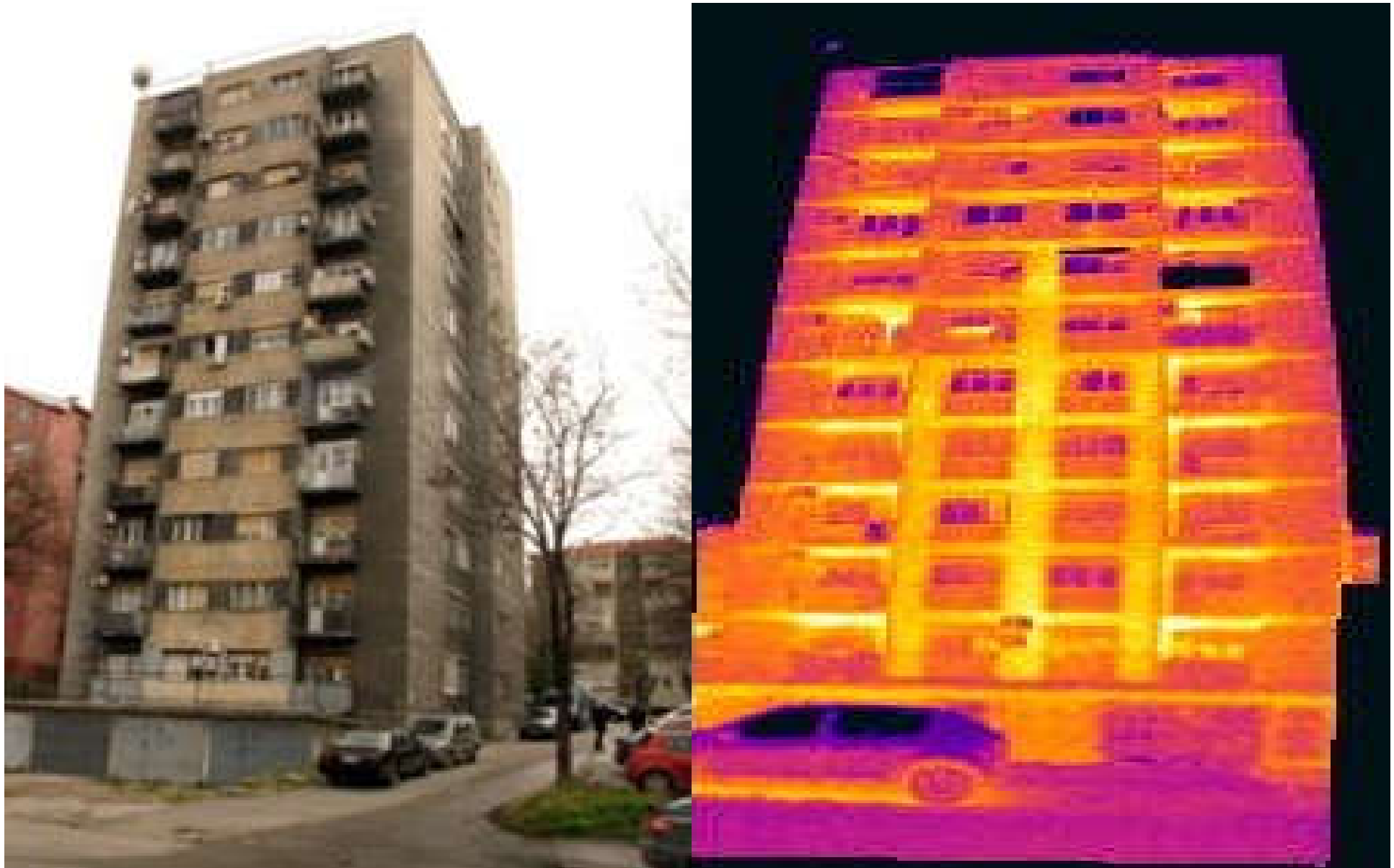
Изглед једне од стамбених зграда на пилот локацији и термовизијски снимак који указује на потрошњу топлотне енергије
